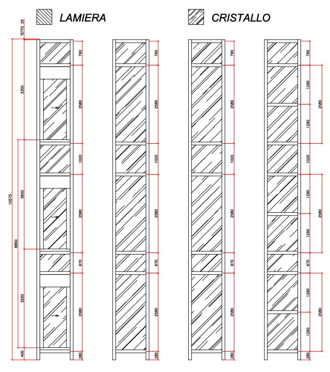
POSIZIONAMENTO TRAVERSE SOPRA E SOTTO LE PORTE DI PIANO E A META' DELLA SPECCHIATURA DELLA PORTA DI PIANO SOLO LATO MECCANICA
